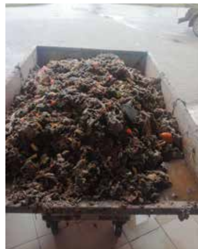
ŚMIECI WYŁAPYWANE NA KRATACH W OCZYSZCZALNI ŚCIEKÓW W SKOCZOWIE
